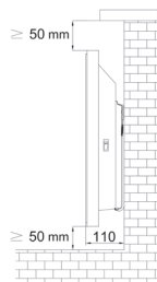
Bild 9. Abmessungen der Standheizkörper in montierter Stellung
