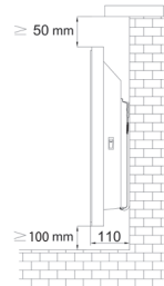
Şekil 9. Konvektörün montaj olmuş ölçüleri
